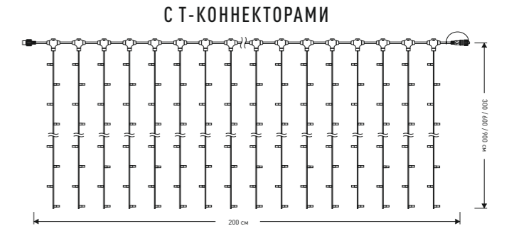
Работает от блока питания 4А (АС/DC)* (занавесы 2x6 м и 2x9 м комплектуются блоками питания)
